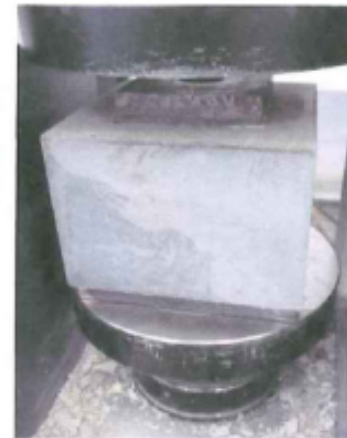
Metodo di prova : compressione sul cubetto cls con cornice metallica inferiore a supporto della camicia REFOR-tec ®
