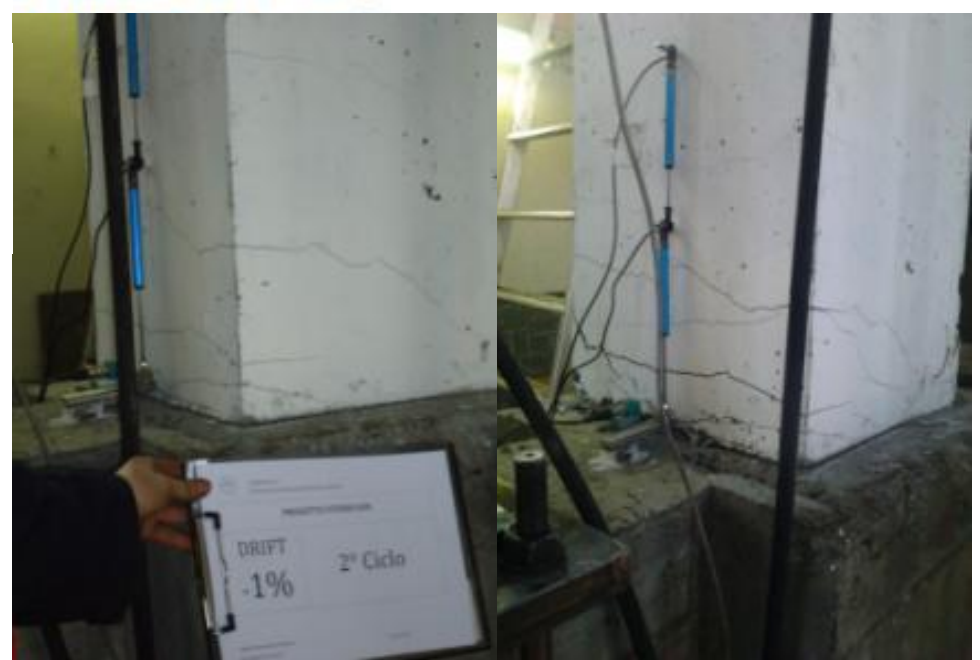
Fessurazioni e crepe evidenti con principio di "spalling" !
