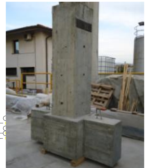
dopo incamiciatura con BS 91 ANCORA tricomponente
