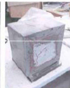
Provino al termine della prova di aderenza a taglio
