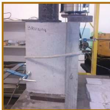
Disposizione degli strumenti di misura sul campione.
