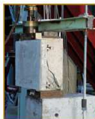
Disposizione degli strumenti di misura sul campione.
