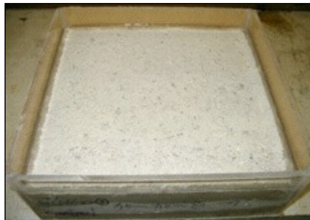
Calcestruzzo trattato con sigillante DPS di Evercem
